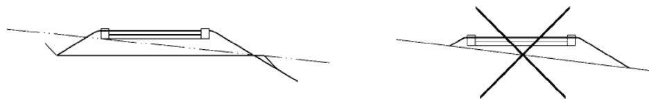
Figure 9 — Exemple de tertre d'infiltration hors sol
