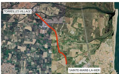
Afin de sécuriser l'approvisionnement de nos communes en eau potable, Eau Agglo procède à la pose de la portion de ce réseau d'interconnexion entre Sainte Marie et Torreilles le long de la RD11. Ces travaux engendreront la mise en place d'une circulation alternée pilotée par des feux de chantier. Ces derniers seront déplacés au fil de l'évolution du chantier. La vitesse sera limitée à 30km/h. Le dépassement, le stationnement et l'arrêt des véhicules seront interdits.
